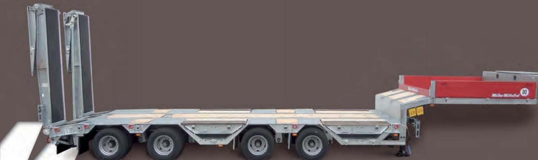
Hydraulische Rampensperrzylinder zur Sicherung ohne Haltegestänge. Geschraubtes Rampenlager für maximale Ladeflächenlänge.
