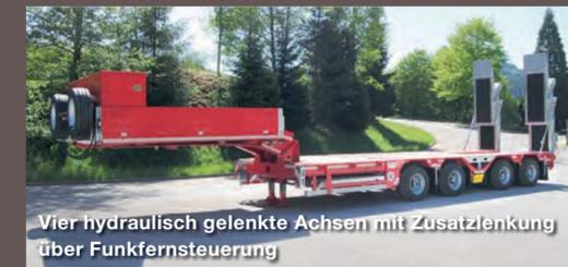
Vier hydraulisch gelenkte Achsen mit Zusatzlenkung über Funkfernsteuerung
