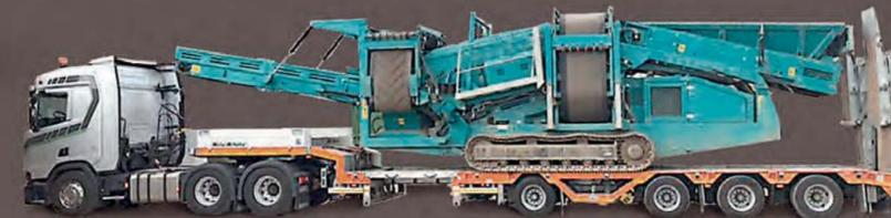
Der Alleskönner Transport von Siebanlage, Radlader, Kettenbagger. Eingeschoben in 16.500 mm mit einer 6x4 Zugmaschine.
