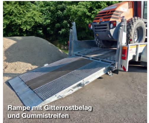
Rampe mit Gitterrostbelag und Gummistreifen
