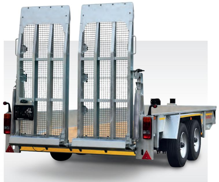
Rampe 870 x 2.350 mm mit Gitterrostbelag
