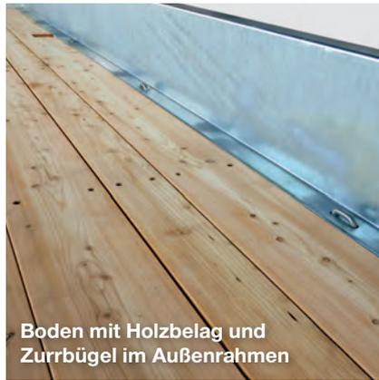
Boden mit Holzbelag und Zurrbügel im Außenrahmen
