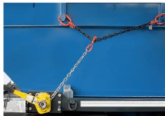
Ratschenspannzug am Außenrahmen montiert
