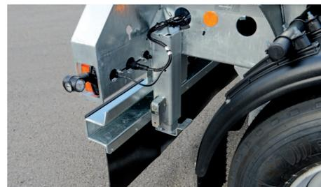
Massiver Unterfahrschutz mit verstellbarer Abstützung
