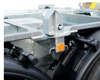
Drehbarer seitlicher Steckanschlag
